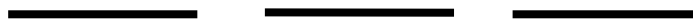
Figura 24: Evacuazione: tre brevi segnali, di un secondo ciascuno, ripetutamente finché il sito non viene evacuato
